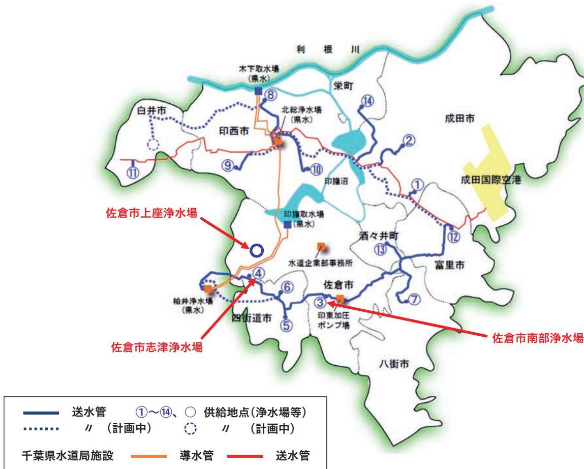
図2-1 佐倉市水道事業における取水から給水までの流れ
