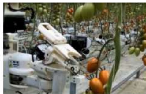
AIがトマトの成熟度を判定する 自動収穫ロボット
