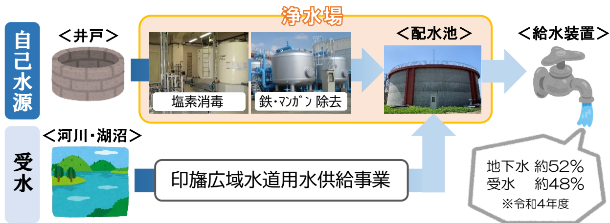
図2-3 水道事業における取水から給水の流れ
