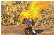
▲在 2025 年 11 月于市内进行的实证实验中，受到撞击的锂离子电池发生起火的情景
