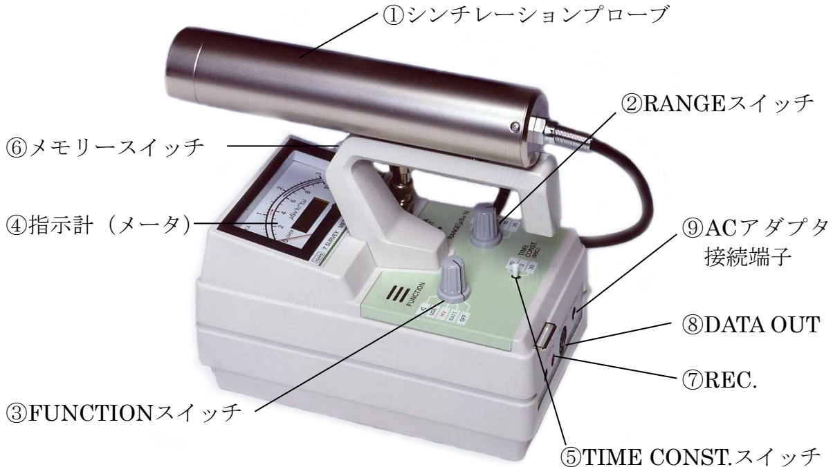
写真Ⅱ.1.1 NaI(Tl)シンチレーション式サーベイメータ (日立アロカメディカル製TCS-161型)
