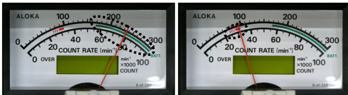
写真 I.1.2 サーベイメータの使用前チェックによる指示例 (左 : BATT.チェック、右 : HVチェック)
