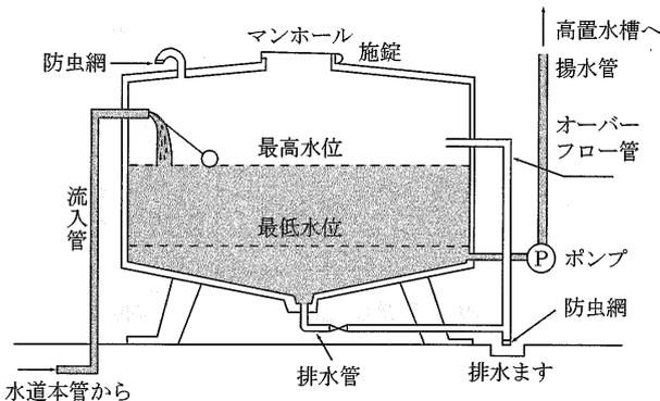
簡易専用水道は、県や市等の水道（水道事業）から供給される水のみを水源として、一旦受水槽に貯留し、高置水槽や圧力タンク等で給水する水道で、受水槽の有効容量が10立方メートルを超えるものが該当します。
