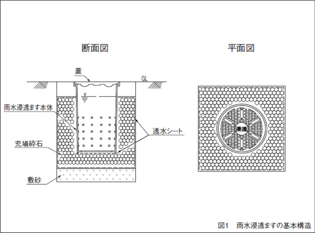
図1 雨水浸透ますの基本構造
