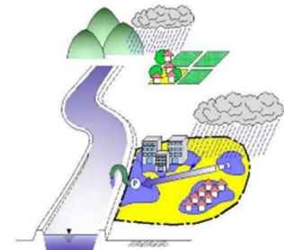
図 内水浸水のメカニズム
