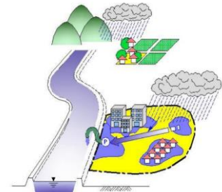
図 内水浸水のメカニズム
