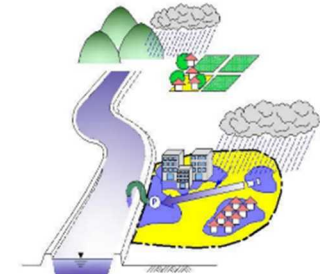
図 内水浸水のメカニズム
