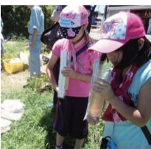
透視時計を作成し、印旛沼の透視度を測ってみよう
