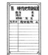
接地埋設標示板
