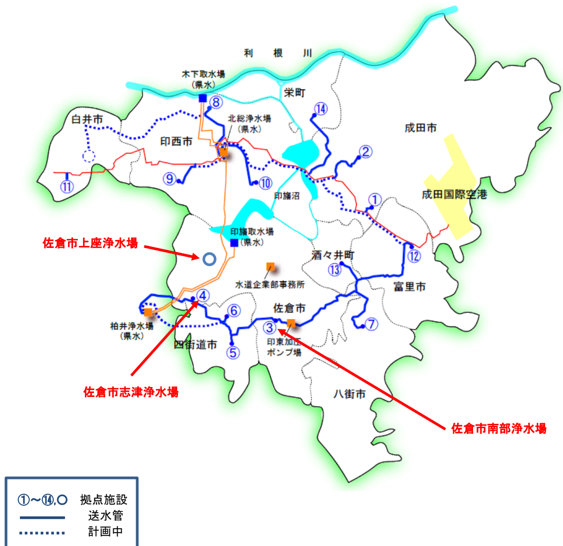
図表 印旛広域水道における送水系統図
