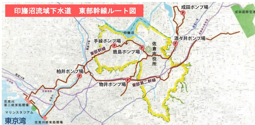
図2-13 佐倉市下水道事業における印旛沼流域下水道を介した汚水処理のルート図
