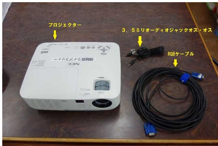
②プロジェクター裏面にRGBケーブル、電源、3.5ミリオーディオジャックを差し込みます
